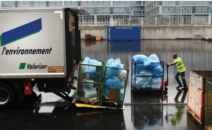
✓ Contrôler le véhicule Avant chaque trajet, ces professionnels inspectent leur véhicule. Ils vérifient par exemple que la plateforme élévatrice fonctionne correctement.
